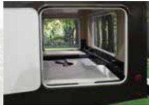
Rangement extérieur pleine largeur - faits de plastique polymère anticorrosion, les compartiments de rangement extérieurs durables et sans joints sont construits pour durer.
