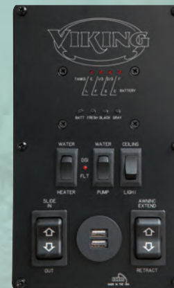
Panneau de contrôle intérieur qui contrôle l'auvent, les lumières intérieures, rallonges, chauffe-eau/pompe, l'indicateur de batterie et deux ports de chargement USB
