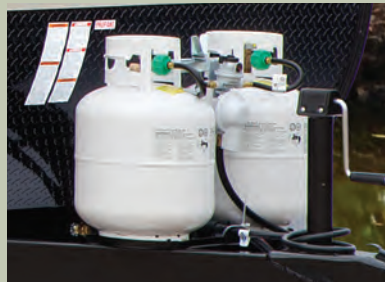
Deux réservoirs de propane de 20 livres
