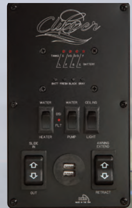
Panneau de contrôle intérieur qui contrôle l'auvent, les lumières intérieures, rallonges, chauffe-eau/pompe, l'indicateur de batterie et deux ports de chargement USB
