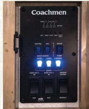
Panneau de contrôle central pour interrupteurs et jauges fermé
