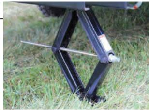
Les quatre robustes stabilisateurs ciseaux se montent et se rétractent très facilement avec une perceuse sans fil avec la mèche qui est fourni.
