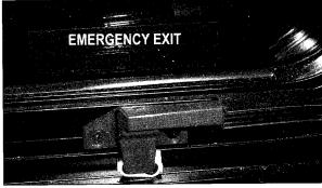
**GENERAL** OPERATION PROCEDURE FOR EMERGENCY WINDOWS-PULL THE RED HANDLE(s) AT THE BOTTOM OF THE WINDOW AND PUSH THE WINDOW OUT.
