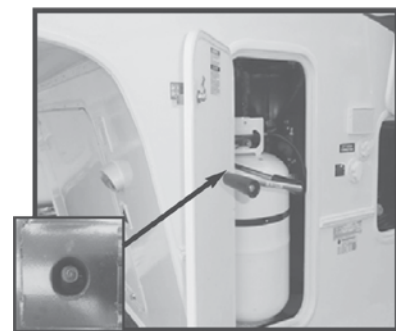
Manivelle de cric pour opération manuelle de la béquille de caravane à sellette dans l'ouverture du mécanisme, à l'intérieur du compartiment de propane.
