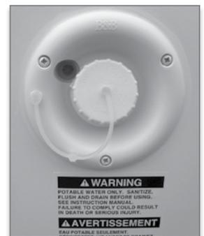
L'autre style a un capuchon qui se dévisse pour y avoir accès. Dans les deux cas, l'eau peut être ajoutée au réservoir en utilisant une chaudière ou un boyau. Il est avisé d'utiliser un boyau de remplissage du réservoir d'eau fraîche de couleur différente de celui utilisé pour la vidange, afin de savoir
