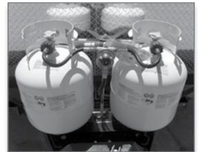
Remplir le contenant à 80% de sa capacité laisse naturellement 20% d'espace pour la vapeur. Cet espace supplémentaire permet le retrait de la vapeur par la connexion Acme QCC1 et permet aussi l'expansion du liquide. Si le réservoir est complètement plein, une hausse de la température extérieure pourrait causer la décharge de gaz propane par la soupape de détente.
