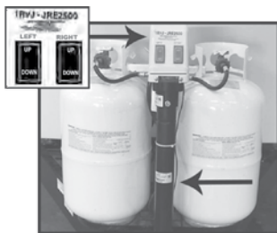
Cric d'attelage électrique de roulotte de voyage
